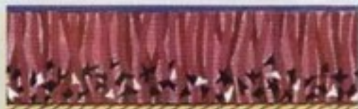
Σημεία συσσώρευσης σκόνη στη βάση του πέλους
